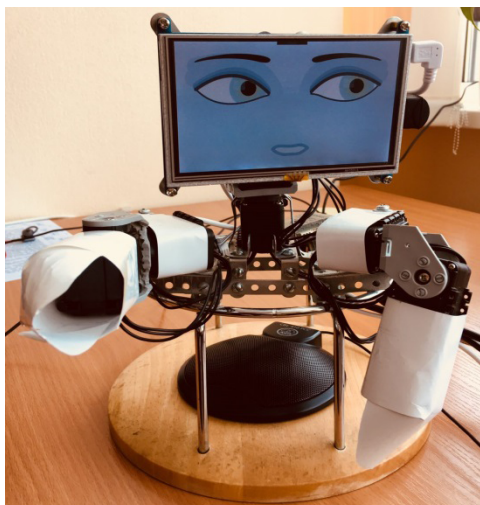
Рис. 7. Совмещение коммуникативных функций на роботе Ф-2: я-размышление (выражается головой и глазами) и остановка-адресата (выражается жестом руки)
